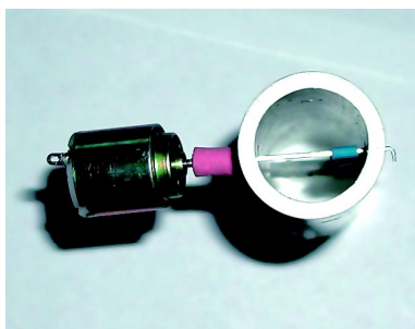
Крепление электромотора к трубке.
