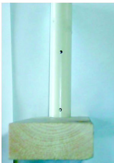
Примерные места сверления отверстий в ПВХ-трубке.
